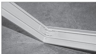
**1.** Fissare i connettori angolari bianchi ai lati dei profilati (come mostrato nella figura), montandone solo tre e lasciando libero uno dei due lati che non verrà fissato al soffitto, per permettere l'inserimento del pannello LED.
